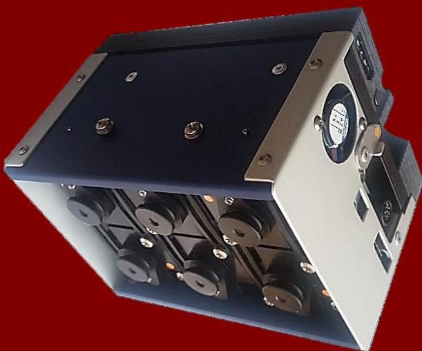
MACAW (マカウ) は、可視/近赤外の6または12バンド画像を撮影するマルチスペクトルカメラです。森林や農地を高速低空飛行するドローンから、瞬時に、対象物のブレや歪みのない画像を撮影できるグローバルスナップセンサを搭載しています。MACAWはすべてのバンドを同期して撮影し、バンド間の位置を自動補正します。フィルタの選択によりユーザオリジナルのバンド構成で、マルチバンド画像やNDVIなどの植生指数画像が作成できます。
