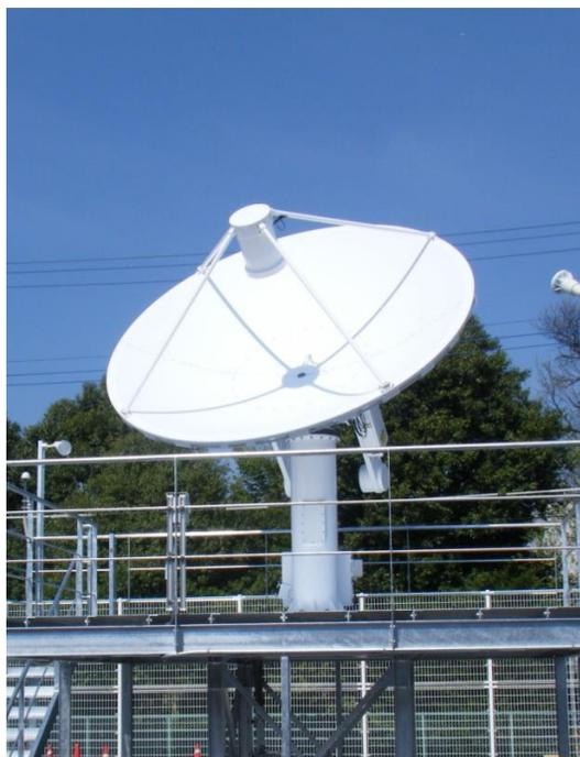
米国Orbital Systems社製3.0m S-バンド衛星送受信システムは、ITU R S.465-5に準拠したアンテナシステムで、送信周波数は、最大100Wまで可能です。アンテナ内部に送受信周波数をシミュレーションできるLoopbackトランスレーター機能を装備し、アンテナの自己診断が可能で、高機能・高性能なアンテナシステムです。
